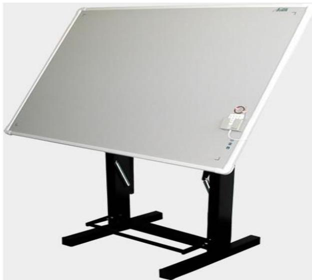
L'ensemble se compose d'un plateau au format A0, avec un capteur 16 boutons et un câble série RS232 et d'un pied.
